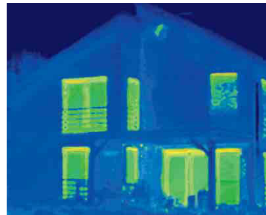
Nach dem sorgfältigen Einbau neuer Schüco Corona CT 70 Rondo Fenster beweist die Thermografie den hohen energetischen Nutzen der Investition. Der ursprüngliche Energieverlust wird nahezu vollständig vermieden.
